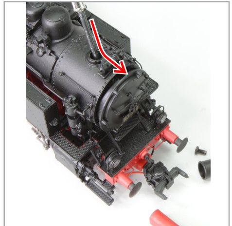
Abbildung 9: Raucherzeuger mit Schraubendreher nach vorne schieben
