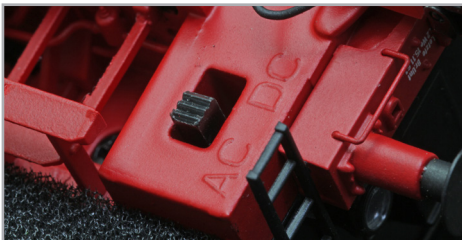
Abbildung 3: Position des Schiebeschalters
