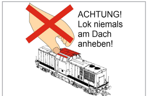
Abbildung 2: Lok niemals am Dach anheben
