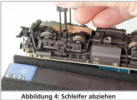
Abbildung 4: Schleifer abziehen
