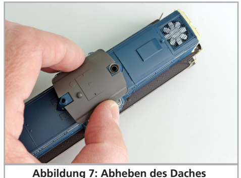
Abbildung 7: Abheben des Daches
