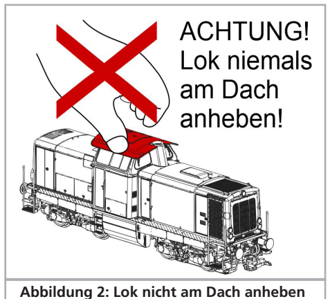
Abbildung 2: Lok nicht am Dach anheben
